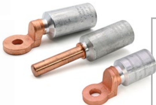
CAA-M, MTA-C, CBMC-N Connecteurs bimétalliques, œillet en cuivre, tube en aluminium.
